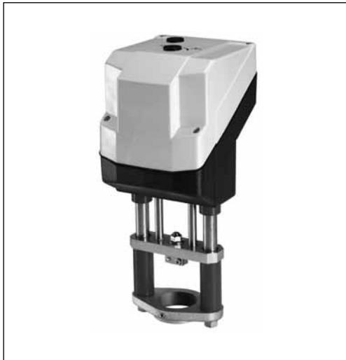
Электроприводы AME 85 и AME 86 предназначены для управления регулирующими клапанами VFS2  $D_y = 65\text{--}100\text{ mm}$  и VF3  $D_y = 125\text{--}150\text{ mm}$ . Электропривод автоматически настраивается на крайние положения штока клапана.
