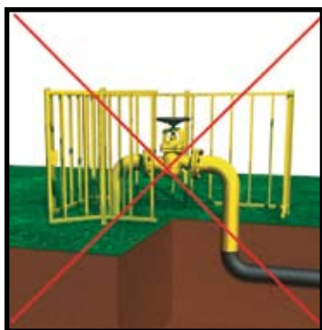
Наземная установка задвижки
